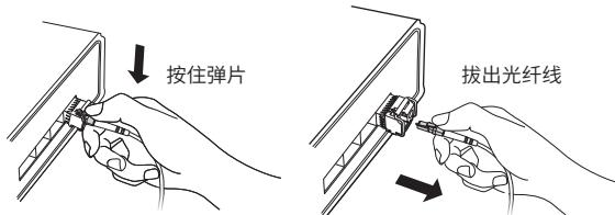
2、将光模块锁扣扳下，手拉住拉环，将光模块平行拔出。
