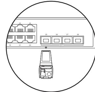
光模块分别插入交换机的SFP+插槽
